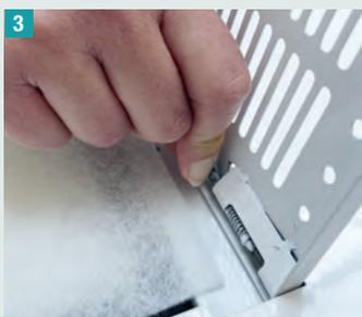
**3** Zum Entfernen des Luftgitters den Schieber am oberen rechten Eck nach links ziehen und Luftgitter herausheben. Deckelverschluss im Uhrzeigersinn drehen, Deckel abnehmen
